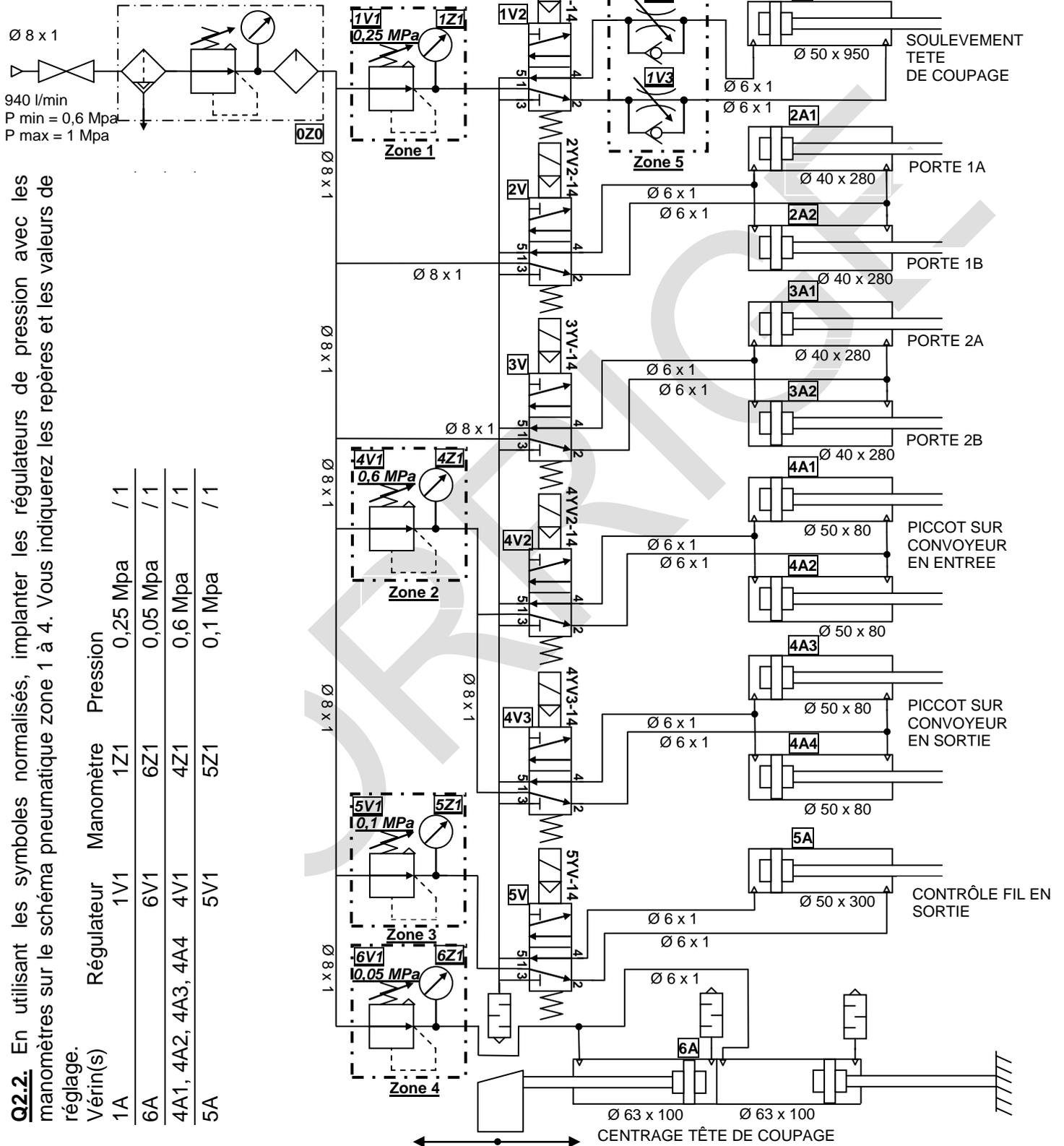
Q2.2. En utilisant les symboles normalisés, implanter les régulateurs de pression avec les manomètres sur le schéma pneumatique zone 1 à 4. Vous indiquerez les repères et les valeurs de réglage.
